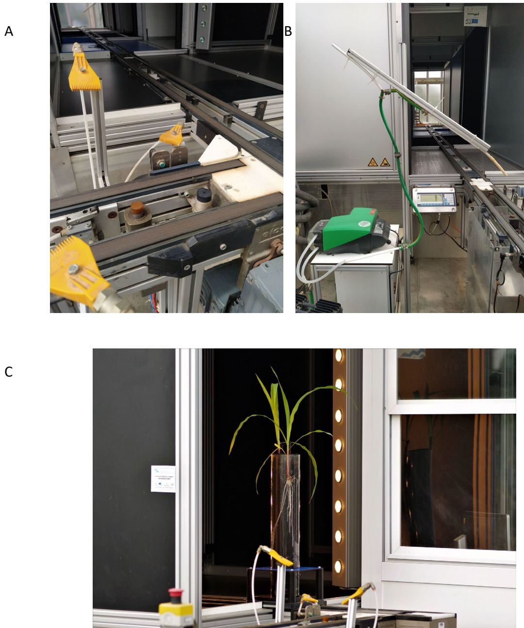
Foto 2. A) Sistema RFID posto all'ingresso delle camere di processamento delle piante. B) Sistema di irrigazione (pompa peristaltica) e pesata (bilancia di precisione). C) Vaso in plexiglass trasparente per analisi dell'apparato radicale.
